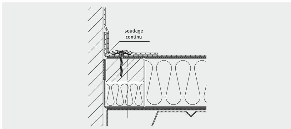
Cette fixation périphérique des membranes d'étanchéité EVALON® peut être réalisée à l'aide d'éléments de fixation homologués disposés en lignes (au moins 3 fixations/mètre).
