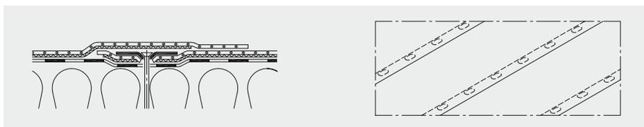
**soit par fixation ponctuelle par système traversant suivant un quadrillage** (fixation en partie courante)<sup>18</sup>
