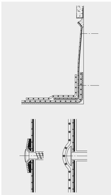
Pour les toitures utilisées, la zone de raccordement doit être protégée des influences mécaniques (par ex. avec le profilé de raccordement mural WA 1 - ÜK d'alwitra).
