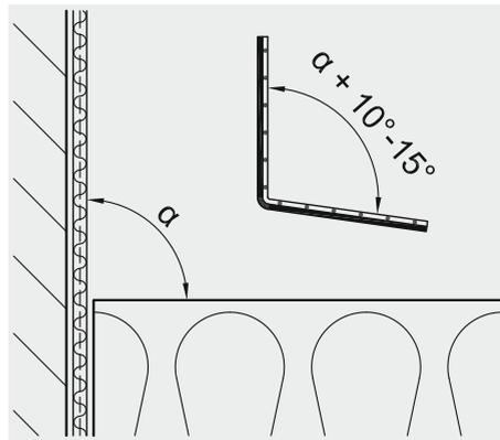
Dans le cas de **bandes de tôles colaminées**, on obtient le même effet en les repliant sur l'arrière.
