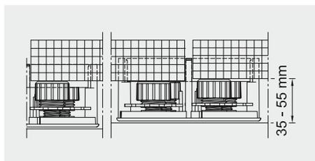
Même après la pose des dalles, la hauteur peut être corrigée à chaque coin de dalle à l'aide d'un tournevis sans qu'il soit besoin de soulever la dalle.
