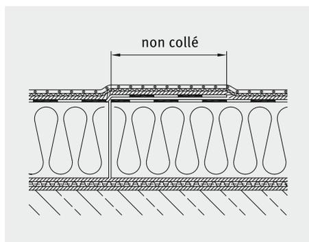
**Ne pas coller les recouvrements des parements bitumineux aux joints des panneaux isolants.**
