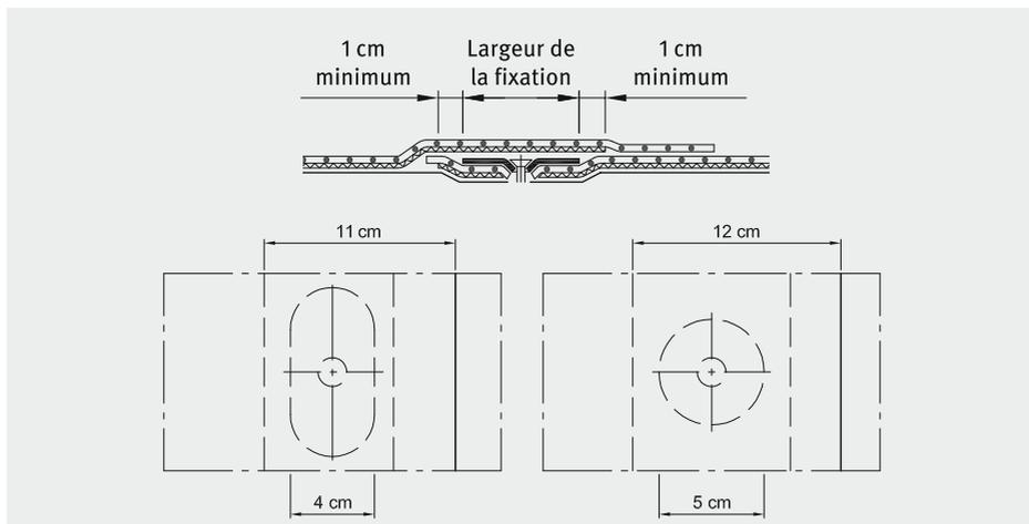
Les membranes d'étanchéité EVALON® comportent plusieurs lignes pointillées en bordure longitudinale des rouleaux. Ce **tracé de repérage** peut servir de **guidage** pour la largeur de recouvrement appropriée qui est
