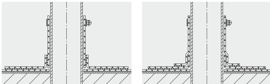
Effectuer une soudure homogène à l'air chaud de la collerette de raccordement avec la membrane d'étanchéité sur au moins 2 cm tout autour du bord extérieur puis assurer l'étanchéité de la manchette avec le collier de serrage en acier inoxydable.
