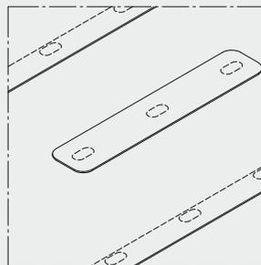
**soit individuellement** avec des rondelles préformées non sous-facées (rondelles EVALON®, diamètre 16 cm) assemblées par thermosoudage.
