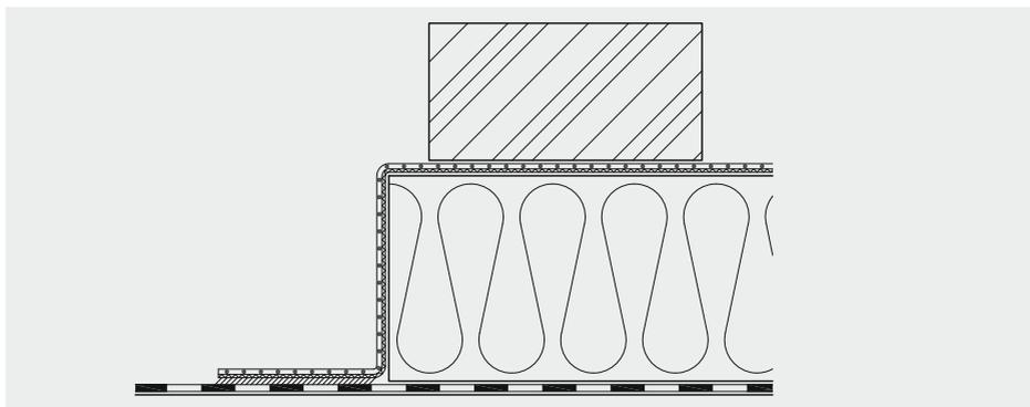
Sur des matériaux où le collage n'est pas admis, par ex. les pare-vapeur PE, la mise hors d'eau peut s'effectuer au moyen d'un morceau de membrane rabattu avec lestage.
