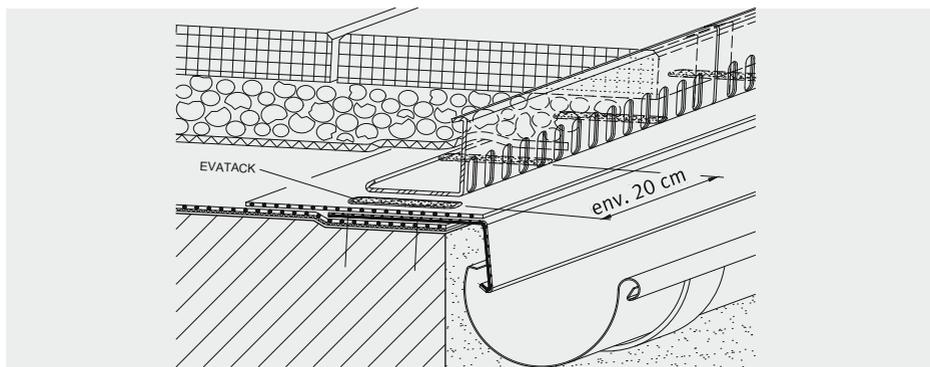
Lors du montage, veiller à une largeur de joint suffisante (se référer au tableau). Pour la zone de joint, utiliser des pattes de jonction.
