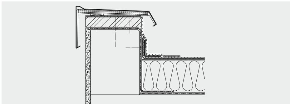
Les membranes de relevé EVALON® VSKA sont fabriquées avec deux bords de soudure non sous-facés (largeurs des membranes de relevé 126 cm / 86 cm / 66 cm) ou un bord de soudure non sous-facé (largeurs des membranes de relevé 63 cm / 43 cm / 33 cm), d'env. 12 cm de large. Les bords de soudure permettent de réaliser une soudure homogène des membranes de relevé EVALON® VSKA avec la membrane d'étanchéité et la cornière en tôle colaminée.
