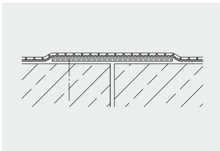
Étanchéité des joints de dilatation de **type II** (DIN 18531) : Le type d'étanchéité au-dessus du joint est déterminé au cas par cas en fonction de l'amplitude et de la fréquence des déplacements, par ex.
