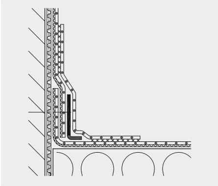
Si les fixations linéaires sont réalisées avec des **profils de rives rigides**, les profils doivent être recouverts de manière étanche d'une bande de recouvrement non sous-facée.
