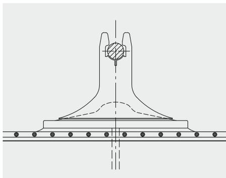
Sur des membranes fixées mécaniquement, placer les supports pour lignes de paratonnerre directement à côté des éléments de fixation de la membrane.
