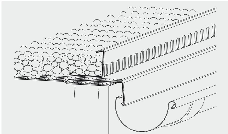
Pour une pente supérieure à 3° et moins de 5°, il faut tout d'abord souder une bande de membrane de relevé EVALON® non sous-facée (largeur env. 20 cm) posée au milieu de la face inférieure du côté non perforé de 8 cm de large du profilé pare-gravier sur toute sa longueur. Ses bords sont ensuite soudés sur la largeur requise, le long de la gouttière, sur le profil pour chéneau en tôle colaminée EVALON® fixé mécaniquement et sur l'étanchéité.
