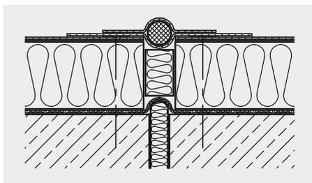
Les joints de type II peuvent être relevés de la surface de l'eau, par ex. avec la mise en place de cales d'isolant ou par des costières métalliques. Les parties de toiture séparées par des joints saillants doivent être traitées comme des relevés et drainées séparément.
