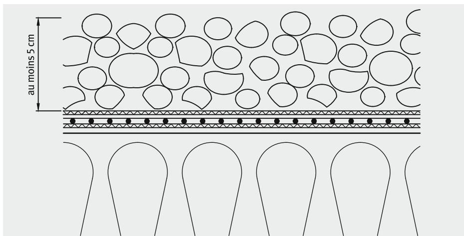
Le gravier de calibre 16/32 a un grammage d'env. 18 kg/m<sup>2</sup> (≈ 0,18 kN/m<sup>2</sup>) par centimètre de hauteur de déversement.
