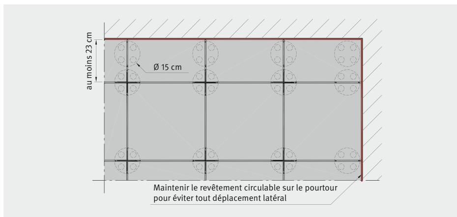
Les têtes de support sont réglables individuellement en hauteur jusqu'à 20 mm avec blocage anti-retour, ce qui permet de compenser les différences d'épaisseur des dalles et d'inclinaison de l'élément porteur dans la limite des tolérances admises. La surface dallée est plane et la pente régulière.
