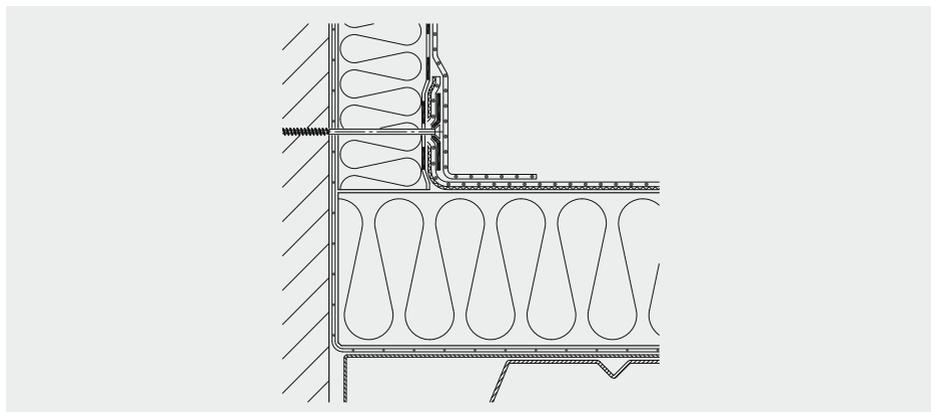
En règle générale, il faut en outre souder la membrane de relevé entre les fixations dans la noue.
