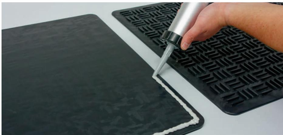
Il est recommandé de poser les dalles avec un espacement de  $\geq 50$  mm. Il se peut que l'EVATAACK soit visible sur les bords. Une cartouche suffit au collage d'env. 3 dalles de circulation.
